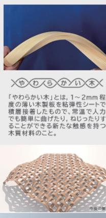
「やわらかい木」は、1~2mm程度の薄い木製板を粘弾性シートで積層接着したもので、常温で人力でも簡単に曲げたり、ねじったりすることができる新たな触感を持つ木質材料のこと。
